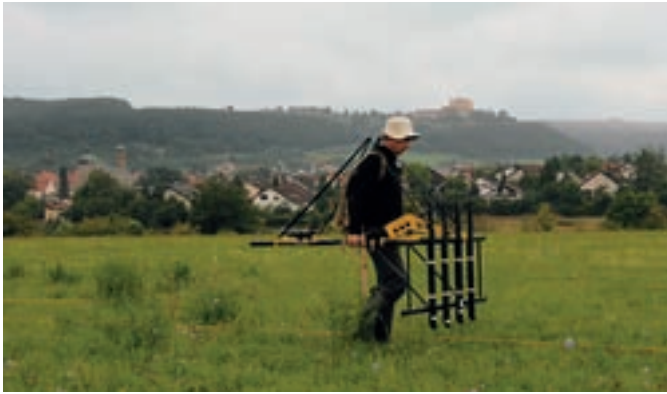
Abb. 92 Das neue 4-Sonden- Fluxgate-Gradio- meter auf dem Lauchheimer Gal- genberg im Einsatz.
